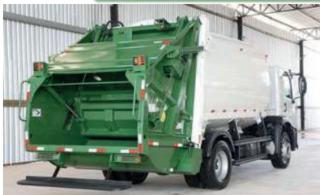
Figura : Veículo compactador.
